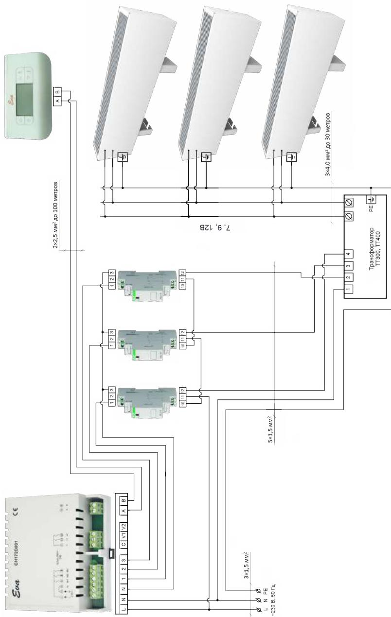
При подключении к трансформаторам TT300, TT400, использовать провод 3x4,0 мм<sup>2</sup> до 30 метров
