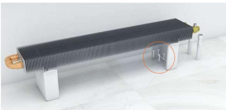
4. Произвести подключение теплообменника. Фитинги теплообменника соединить с подводящими трубопроводами системы отопления. При подключении использовать динамометрический ключ во избежании деформирования тонкостенных медных труб теплообменника и повреждения сварных соединений. Момент затяжки не должен превышать значение 120 Н·м;
