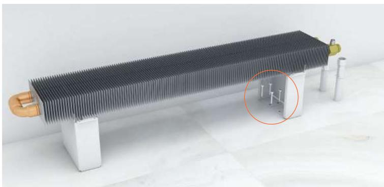
4. Произвести подключение теплообменника. Фитинги теплообменника соединить с подводящими трубопроводами системы отопления. При подключении использовать динамометрический ключ во избежание деформирования тонкостенных медных труб теплообменника и повреждения сварных соединений. Момент затяжки не должен превышать значение 120 Н·м;
