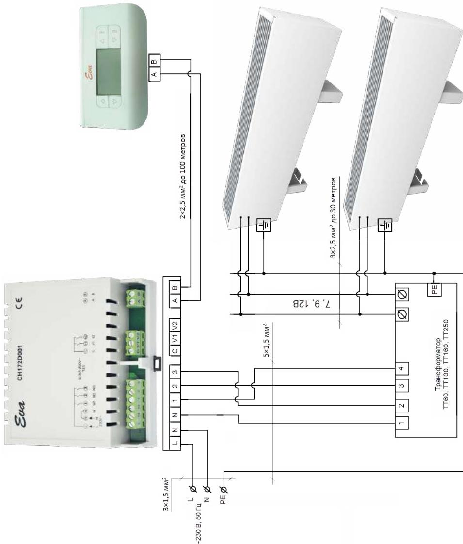
При подключении к трансформаторам ТТ60, ТТ100, ТТ250 использовать провод 3x2,5 ММ<sup>2</sup> до 30 метров
