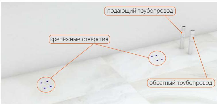
3. Установить конвектор, после чего закрепить корпус к основанию, с помощью крепёжных винтов через отверстия в ножке корпуса;
