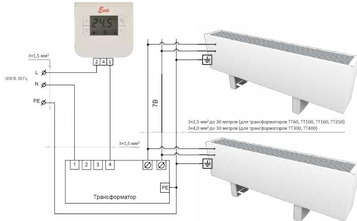
При подключении к трансформаторам TT60, TT100, TT160, TT250 использовать провод 3x2,5 мм<sup>2</sup> до 30 метров
