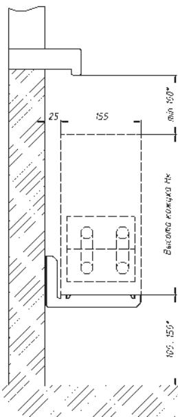
Расстояние между осями крепёжных отверстий при настенном монтаже (на кронштейнах)
